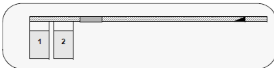
Abbildung 28: Zwei Komponentendosierer und Durchflussmessung
